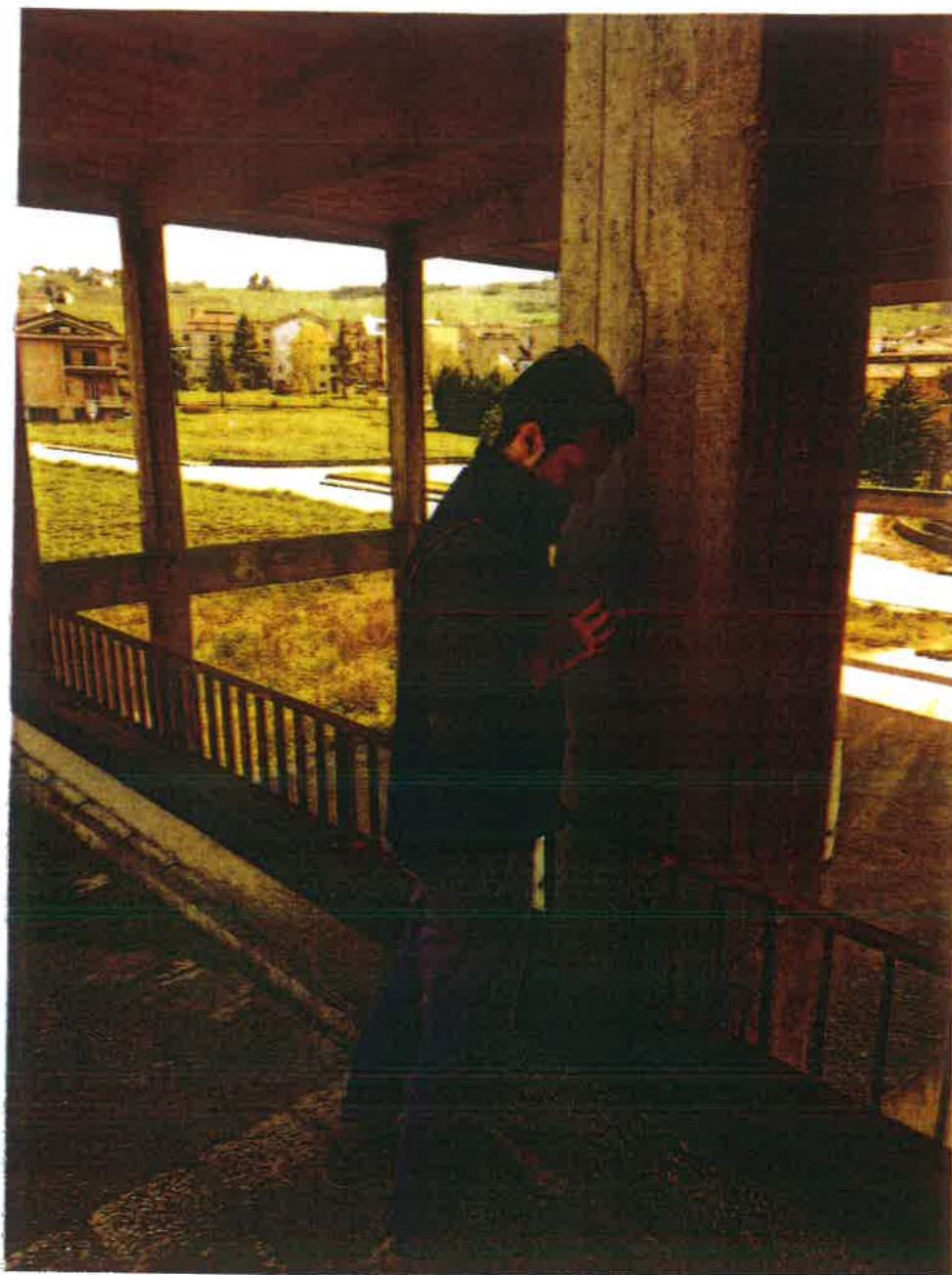
Prova con sclerometro per prova combinata SonReb
