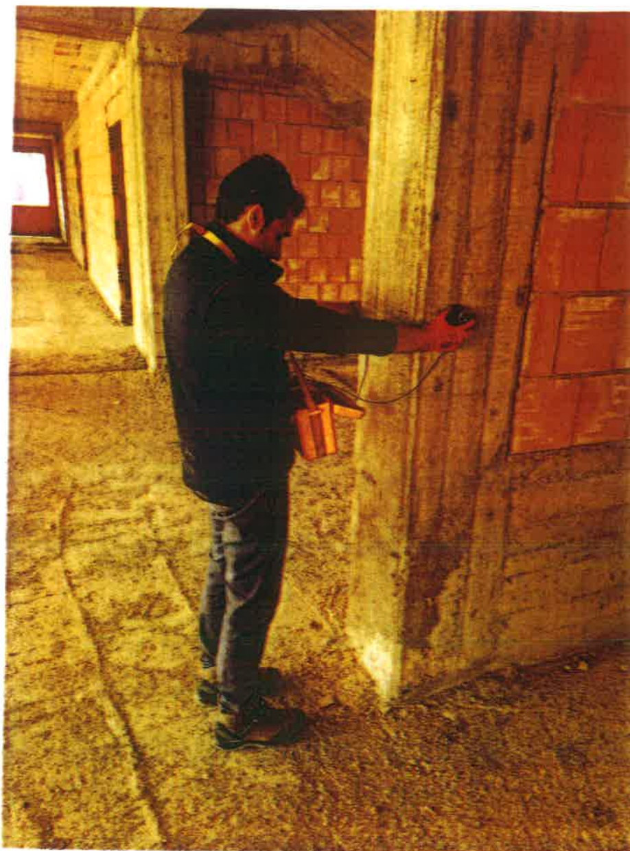
Prova con ultrasuono per SonReb pilastro Corpo B
