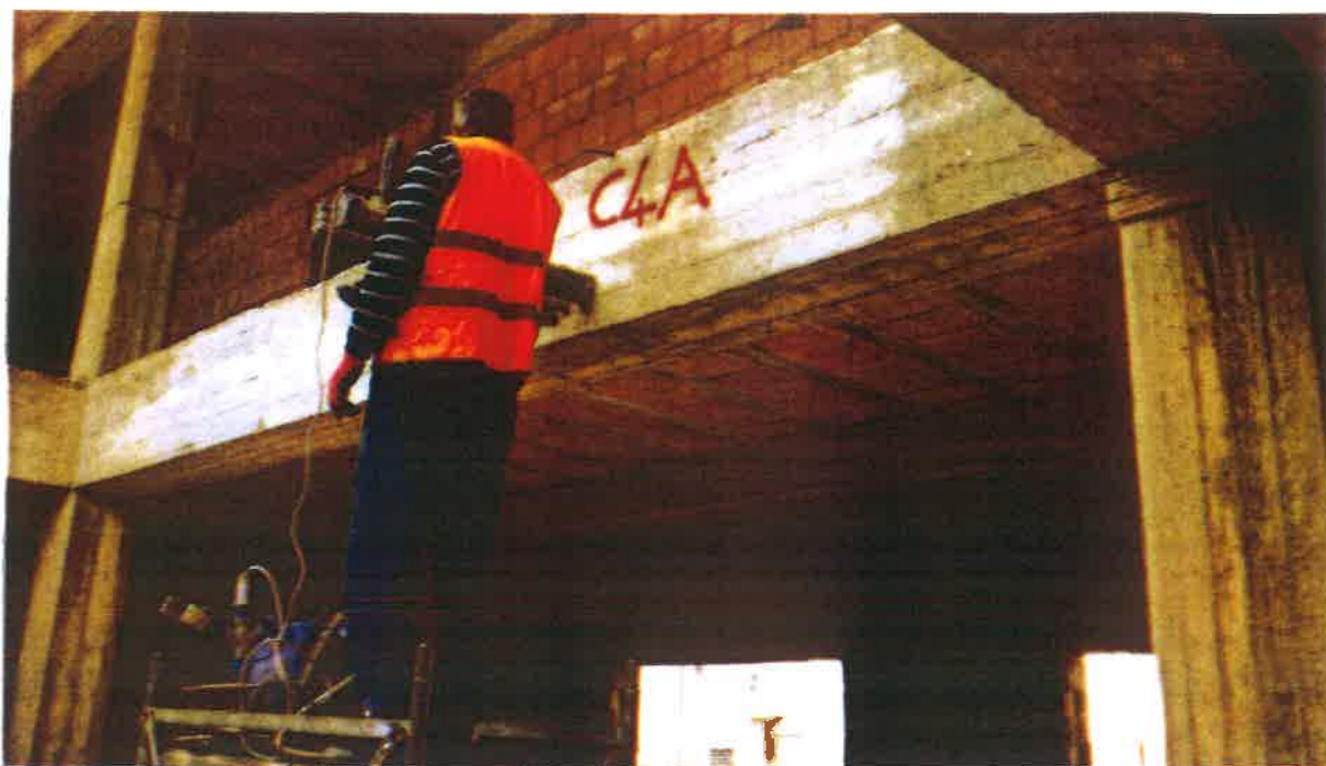
Esecuzione carotaggio su trave Corpo A
