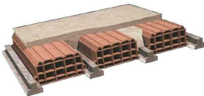
Figura 9; Solai latero-cemento esistenti con travetti in c.a.p.
